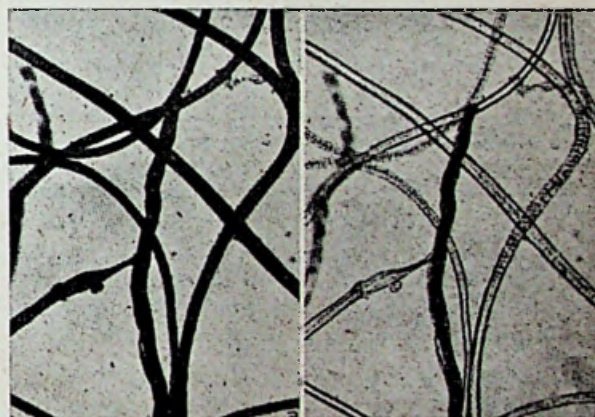
Fig. 6. — Vezelmenging van een beschadigde stof. De infrarode microfotografie (b) toont zeer duidelijk de wol-, katoen- en rayonvezels; (a) microfotografie bij gewoon licht. (Oorspronkelijke fotografie van het speciaal microfotografisch laboratorium van de Th. Böhme, te Chemnitz, overgedrukt in «Nature» van 1 November 1937).
